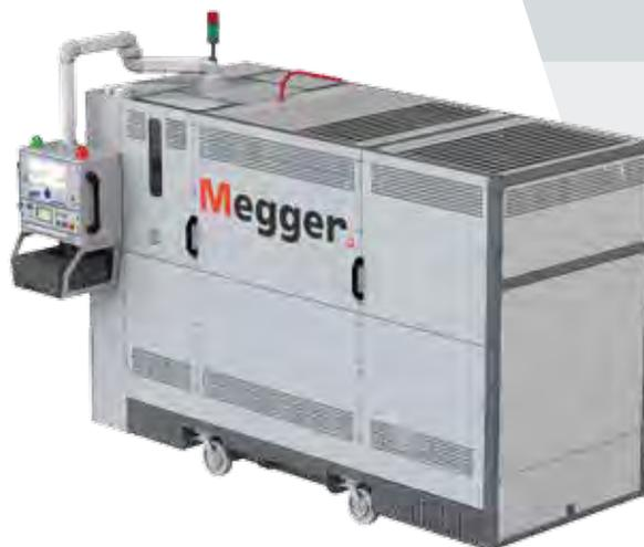
**Test VLF haute capacité
