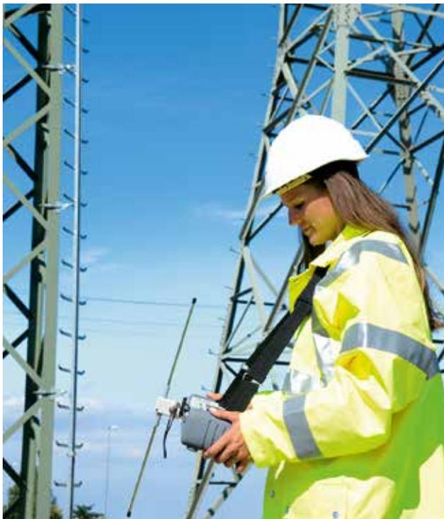
Le détecteur UHF PD est l'outil idéal pour des contrôles rapides et non intrusifs dans des postes électriques MT et HT, indispensable pour les équipes de maintenance. Grâce à une bande passante élevée, la méthode Ultra Haute Fréquence (UHF) fournit des mesures précises de décharge partielle sous tension sur des composants HT tels que les terminaisons de câbles, les parafoudres, les transformateurs de tension et les isolateurs électriques.
