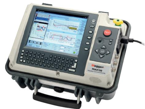
La mesure est facile à réaliser en capturant une empreinte unique du transformateur. Tous les modèles de la série FRAX respectent et surpassent les spécifications relatives à la réponse en fréquence de balayage des normes internationales telles que CEI 60076-18, CIGRE 342, IEEE C57.149, et DL/T-911.
