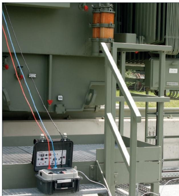
temporisation), l'indice de polarisation, le rapport d'absorption diélectrique et bien d'autres paramètres. Ces modèles incluent des batteries à recharge rapide et fonctionnent à partir d'une source d'alimentation CA lorsque la batterie est déchargée.
