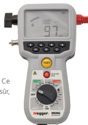
Ce micro-ohmmètre peut être utilisé partout pour mesurer de faibles valeurs de résistance avec une grande précision. Le MOM 2 fait appel à un supercondensateur pour générer le courant de sortie élevé nécessaire pour la mesure des faibles résistances.
