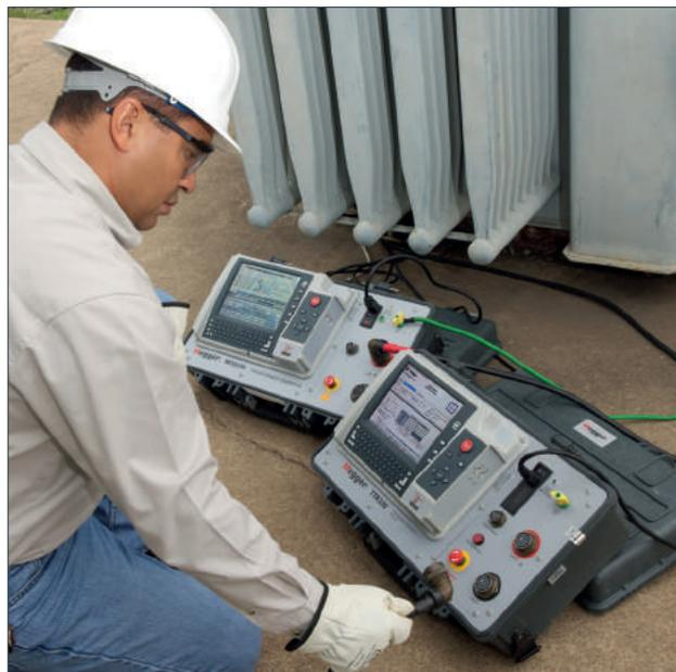
Le jeu de cordons triphasés de notre modèle MTO 300 est entièrement interchangeable avec ceux des ratiomètres de la gamme TTR, afin réduire la durée des tests et d'augmenter la sécurité lorsque ces deux mesures sont réalisées ensemble.
