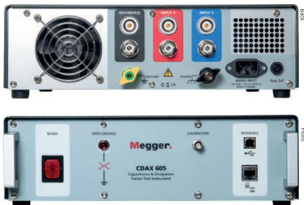
Le CDAX est un instrument de précision utilisant une capacité directe (vecteur) et un pont capacitif combinés à un ensemble de test de facteur de perte nécessitant une source d'alimentation CA externe pour former un dispositif de mesure complet des charges capacitatives, résistives et inductives.
