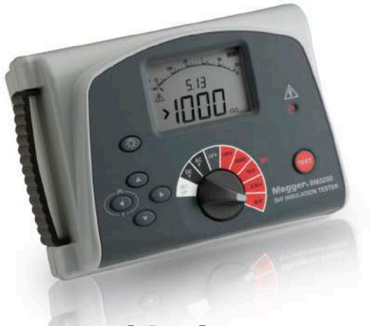
Les tests d'isolement CC sont réalisés à 250 V, 500 V, 1000 V, 2500 V, 5000 V. Il mesure la résistance d'isolement depuis 100 k $\Omega$  jusqu'à 1000 G $\Omega$ . Le BM5200 intègre une fonction de décharge automatique des circuits capacitifs et affiche la tension résiduelle.
