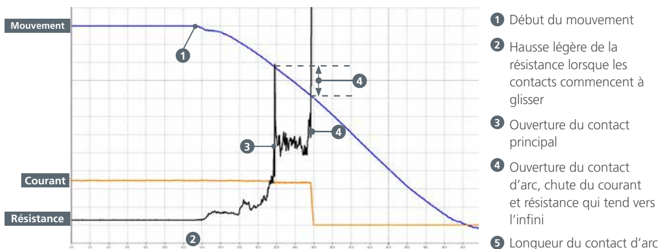
La mesure de résistance dynamique est une méthode fiable pour estimer la longueur / l'usure d'un contact d'arc
