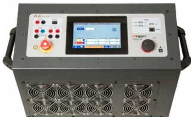
La gamme TORCEL™ 900 permet de réaliser des tests de décharge, le seul moyen de déterminer la capacité d'une batterie. Avec les enregistreurs de tension de batterie BVM optionnels, raccordés directement au TORCEL 900, l'unité devient un système complet et autonome de test de décharge.
