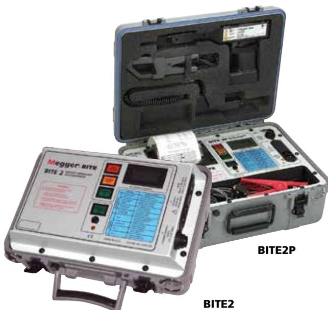
Les testeurs d'impédance de batterie BITE2 et BITE2P déterminent l'état des cellules plomb-acide et nickel-cadmium jusqu'à 7000 Ah. Les BITE2 et BITE2P mesurent les changements chimiques internes de la batterie dus à son usure. Ces effets peuvent être causés par la corrosion du support, sa sulfation, son assèchement, carbonatation, dépoliarisation négative etc.
